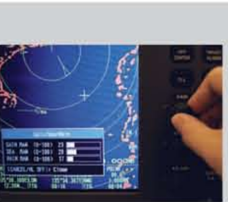
Специальные поворотные переключатели, регулирующие функции GAIN/STC/FTC для эффективной работы.
